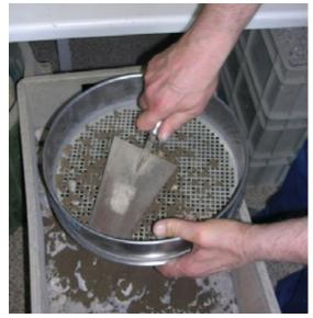
Figure A1.18 - Pulverisation test (© BRRC)
